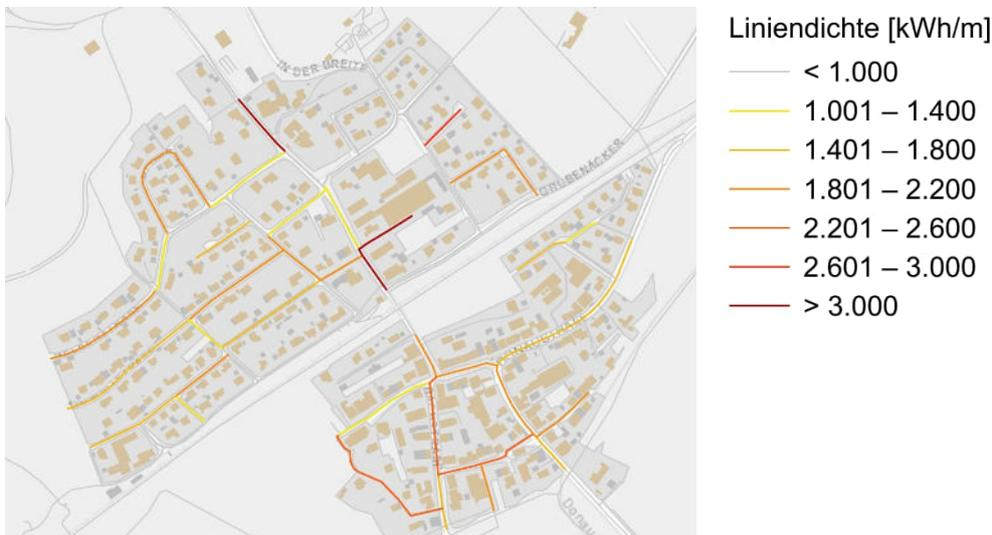
Abb. 41: Wärmedichte Stetten – Liniendichte
