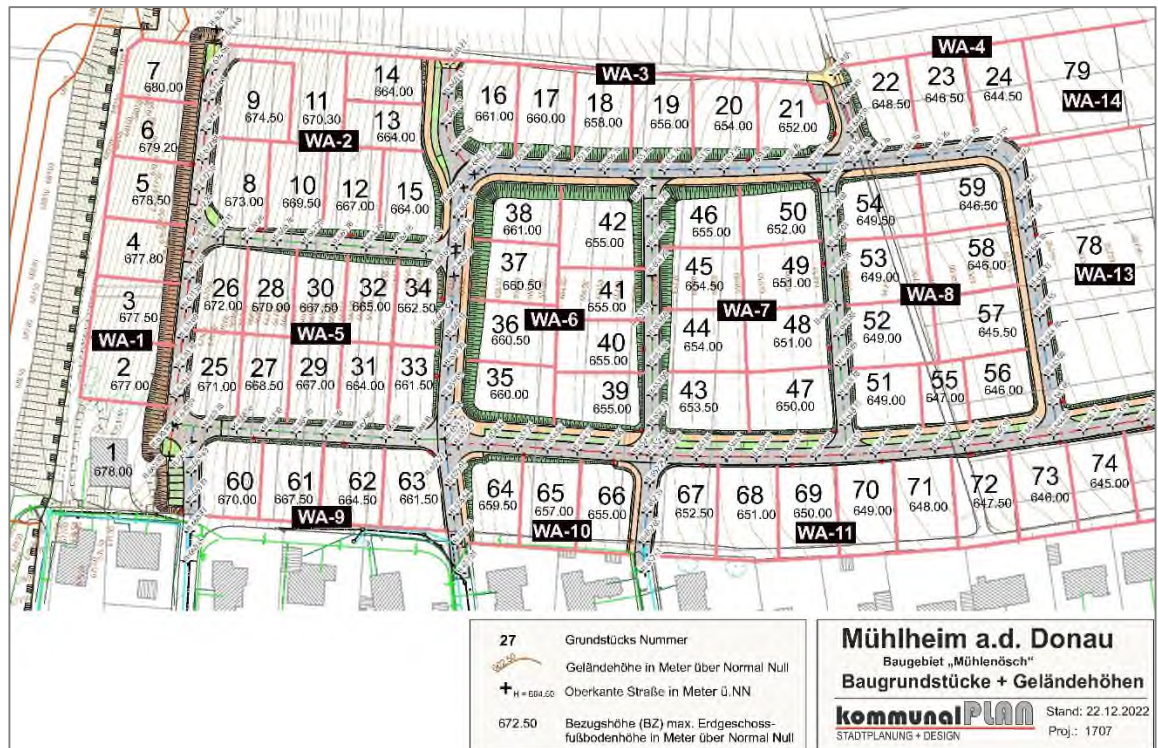
Abb. Baugrundstücke mit Geländehöhen, Bezugshöhen und Straßenhöhen
